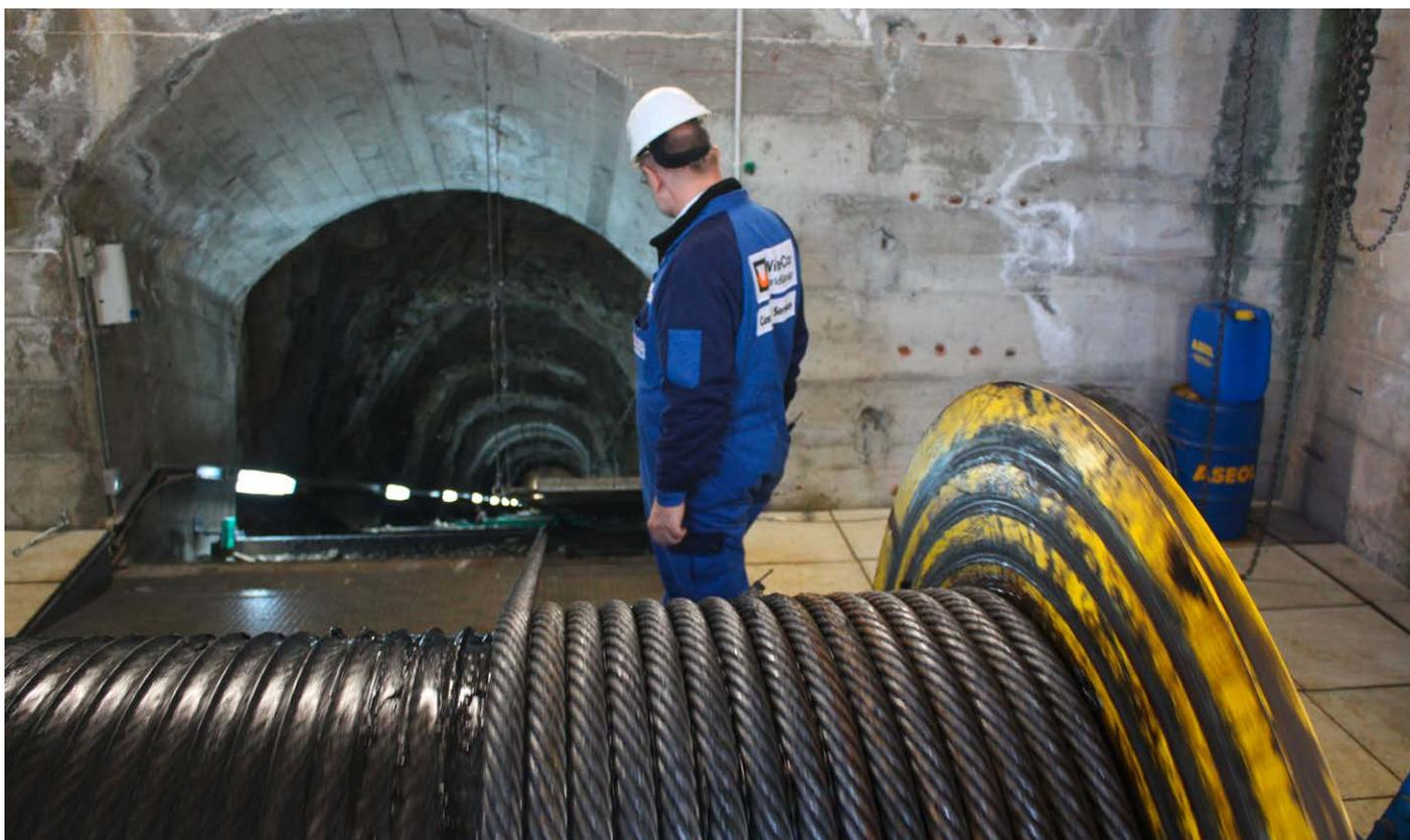
wir nun konstruktiv Einfluss auf die Seilebensdauer zu nehmen indem wir die Abriebfestigkeit erhöhen. Die Umstellung von Turboplast zu Duroplast bedeutet den Wechsel von einer 8x26 Warrington-Seale Konstruktion zu einer 8x17 Seale Konstruktion. Seale Konstruktionen zeichnen sich durch besonders dicke Drähte in den Außenlitzen aus und sind dementsprechend widerstandsfähig gegen äußere Beschädigung/Abrasion.
